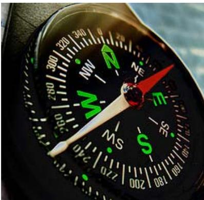
Es después del mapa el instrumento más importante para el orientador. Se trata de un instrumento que lleva una aguja imantada que siempre señala al norte magnético. Existen muchas clases de brújulas y las que se utilizan para orientación son **transparentes y de limbo móvil**.
